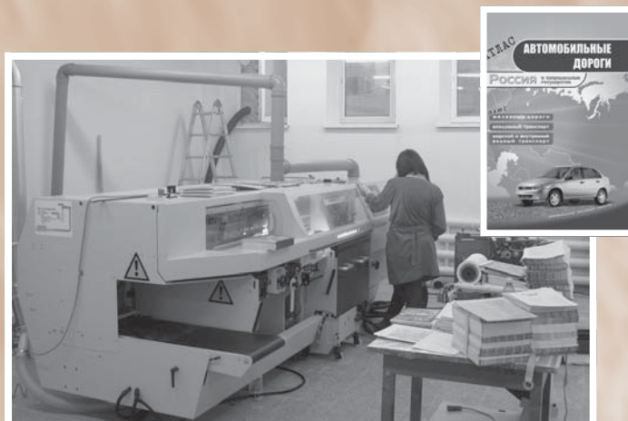
Пусконаладочные работы на машине для бесшвейных скреплений книжных блоков в новом здании ФГУП «Омская картографическая фабрика». 2009
