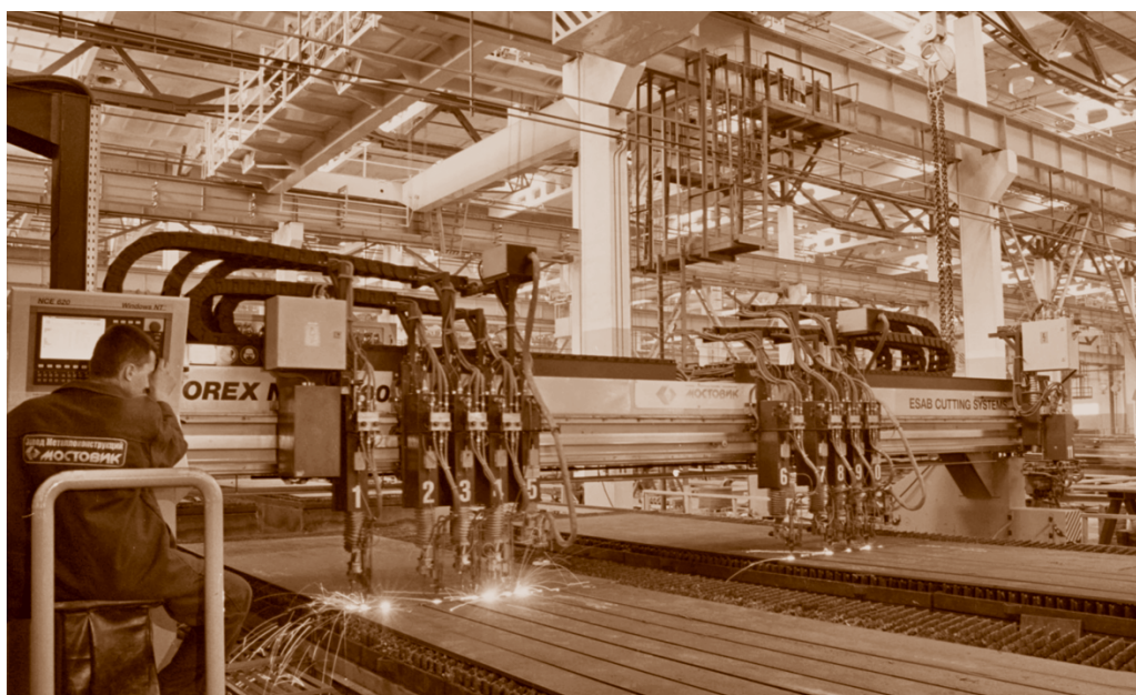
Установка кислородной резки «Esab» на заводе металлоконструкций НПО «Мостовик»*. 2007
