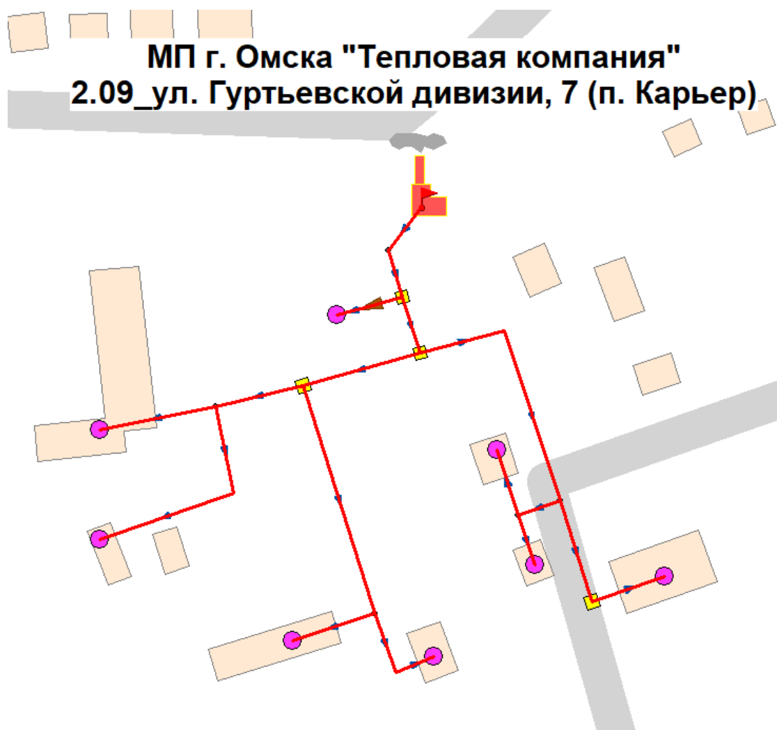
Рисунок 2.12. Схема тепловых сетей от котельной по ул. Гуртьевской дивизии, 7 (п. Карьер)
