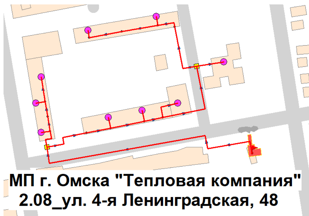
Рисунок 2.11. Схема тепловых сетей от котельной по ул. 4-я Ленинградская, 48
