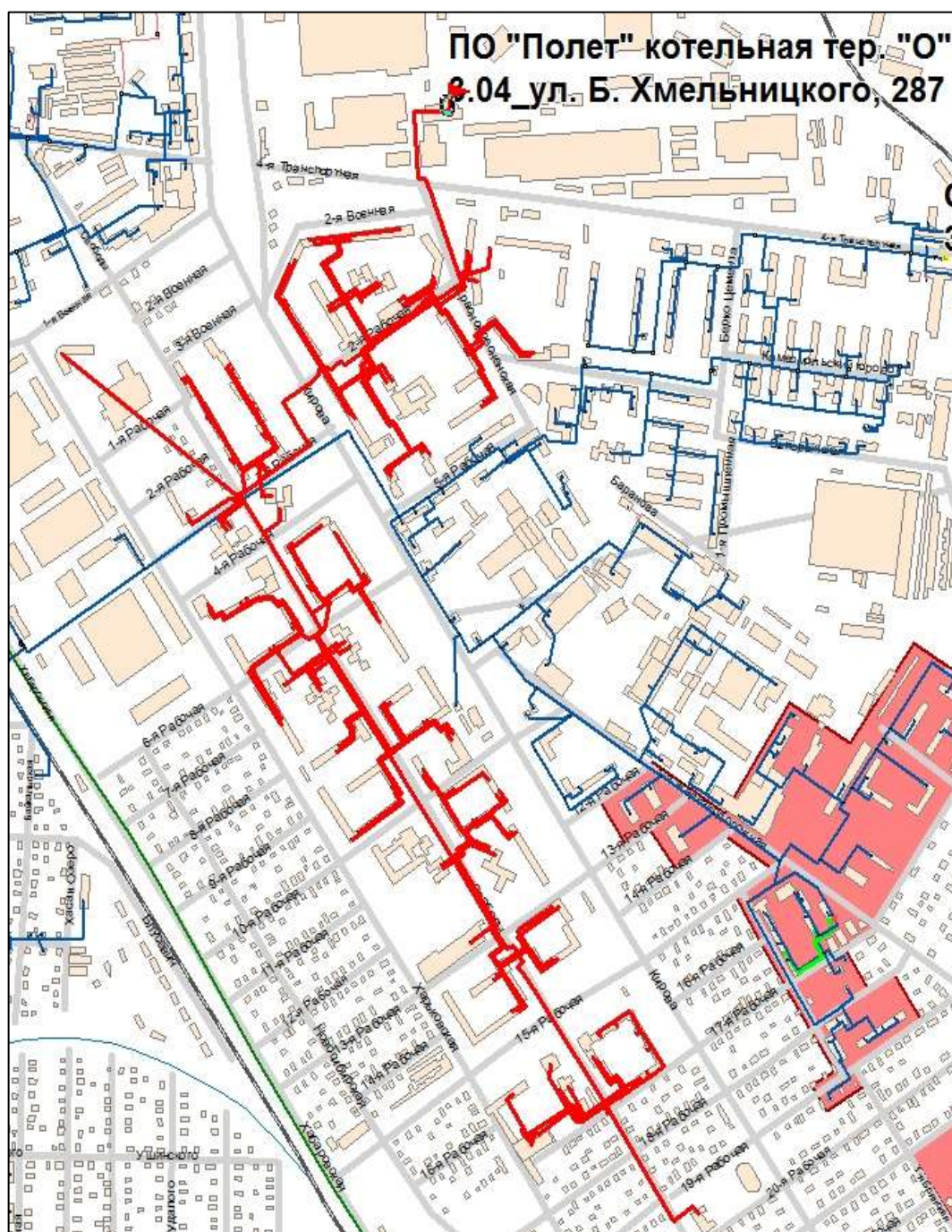
Рисунок 3.11. Схема тепловых сетей от котельной по ул. Б.Хмельницкого, 287 ПО «Полет» филиал ФГУП «ГКНПЦ им. М.В.Хруничева»
