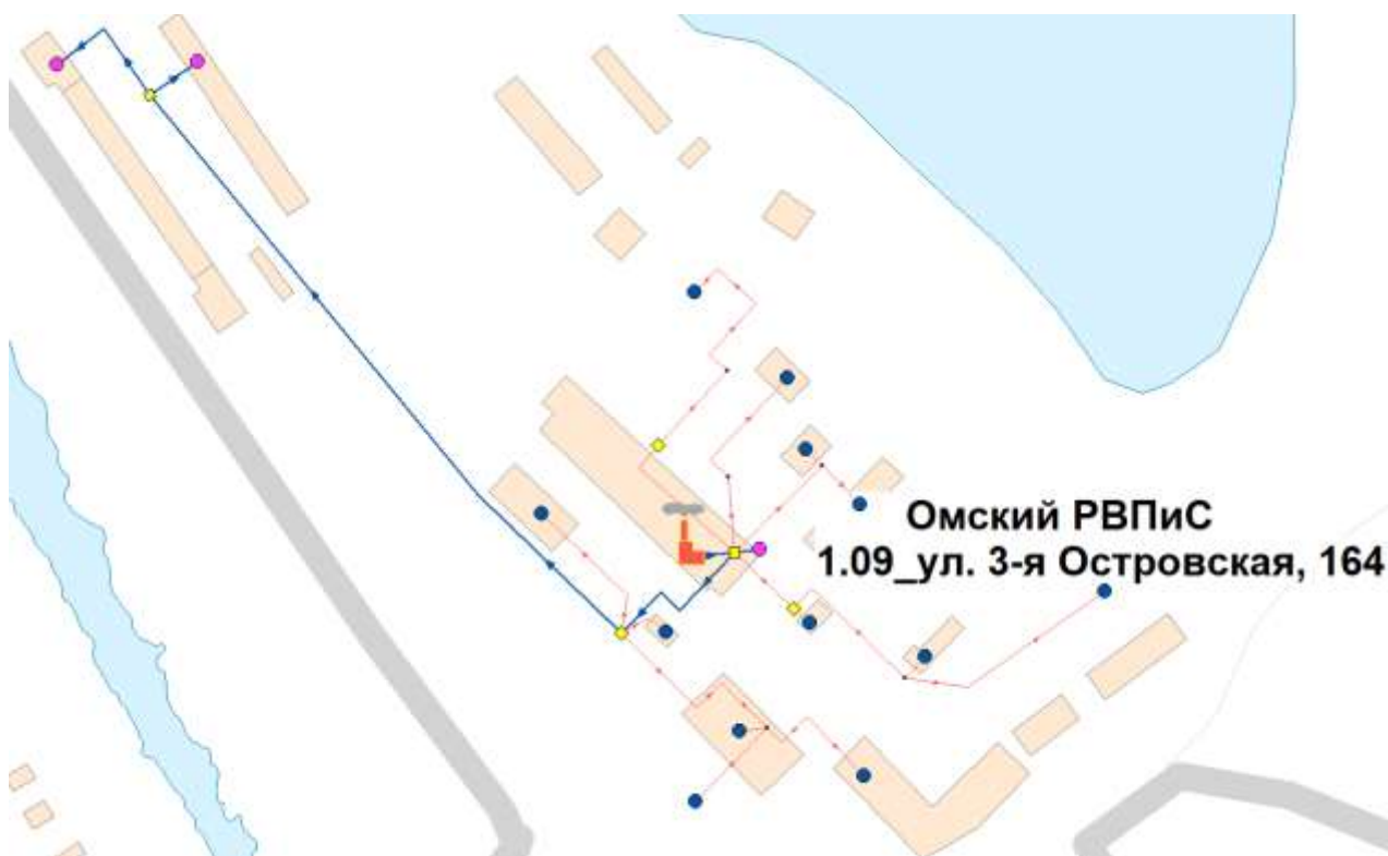
Рисунок 3.2. Схема тепловых сетей от котельной по ул. 3 Островская, 164 Омский РВПиС
